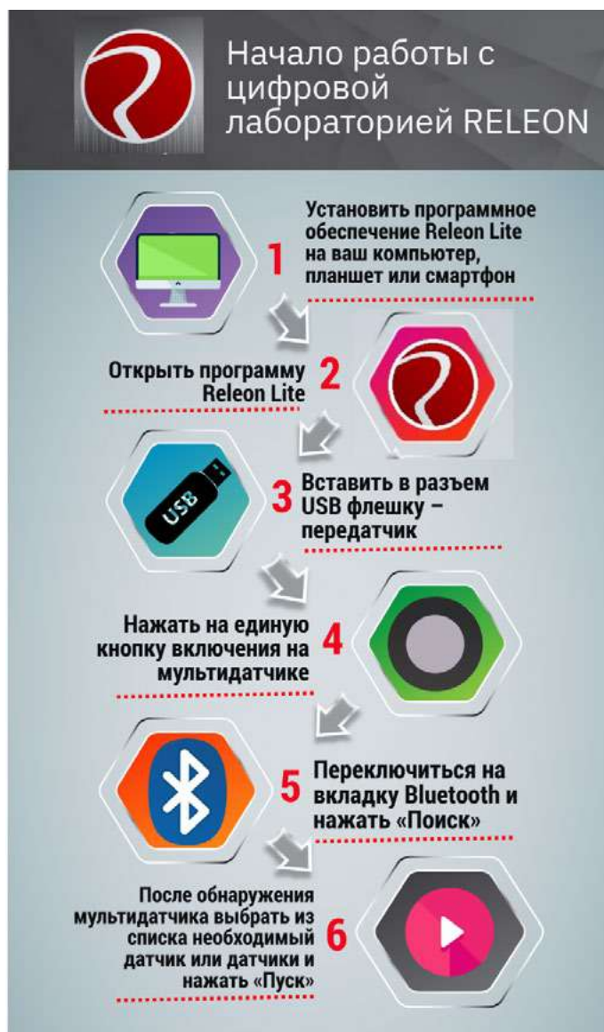
Рис. 21. Инфографика «Начало работы с цифровой лабораторией Releon»
