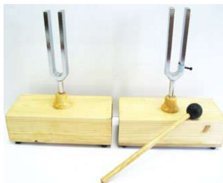
Рис. 3. Камертон на резонаторном ящике
