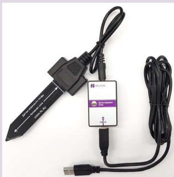
Рис. 4. Датчик влажности почвы
